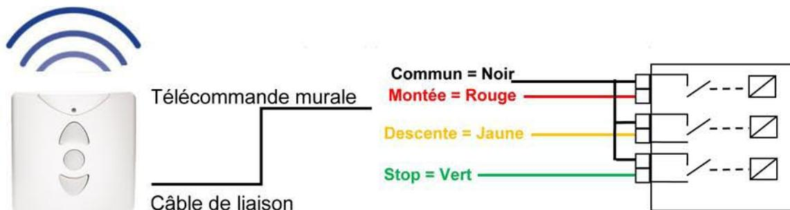
Exemple d'application avec commande déportée filaire
